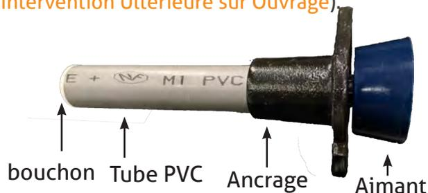
Il est noyé dans la maçonnerie à la construction ou implanté après perçage dans le cadre d'une réhabilitation avec tige filetée et écrou. La pose entre banches se fait idéalement avec les aimants coniques ou en attache sur le ferrailage.
