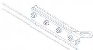
Présenter l'ancrage pour toiture joint debout au-dessus du joint debout.
